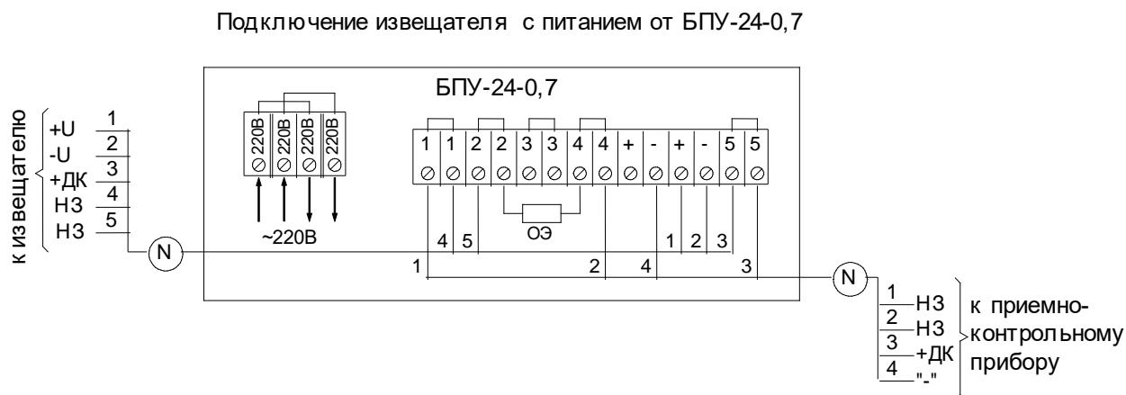
Рисунок 2.12 – Схема подключения извещателя к блоку питания «БПУ-24-0,7»
